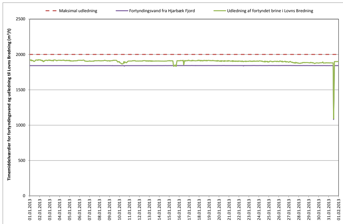
Figur 3 Flow af fortyndingsvand fra Hjarbæk Fjord og flow af udledt fortyndet brine til Lovns Bredning
